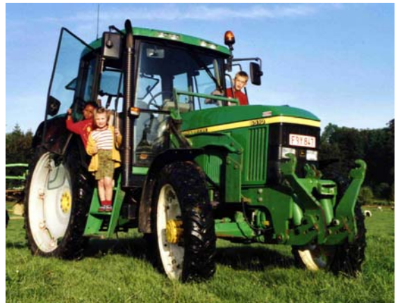
Photo 3 : Tracteur dont le système de transmission hydraulique fonctionne avec une huile biodégradable à base d'huile végétale, garantie par le constructeur.
