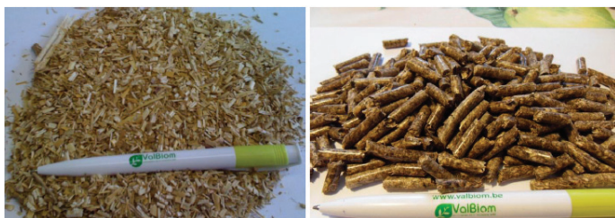
→ Le résidu de criblage de miscanthus et les pellets produits. (Source: ValBiom).
