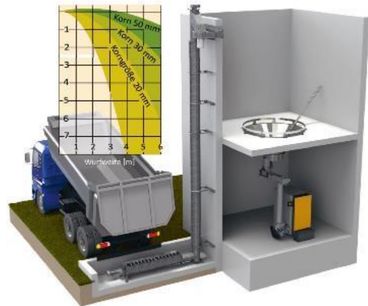
2. Camion benne, vis de remontée avec gicleur et vis pendulaire vers la chaudière
